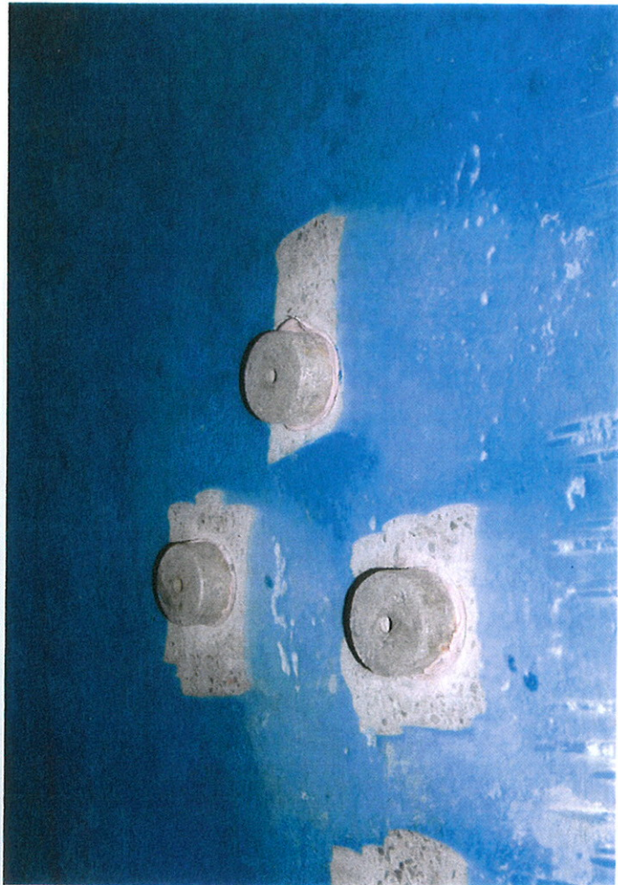
Zkoušky přídržnosti na stěně
